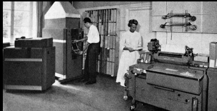
Interiör från maskincentralen. Kalkylator IBM 604 och IBM 416 i arbete.
